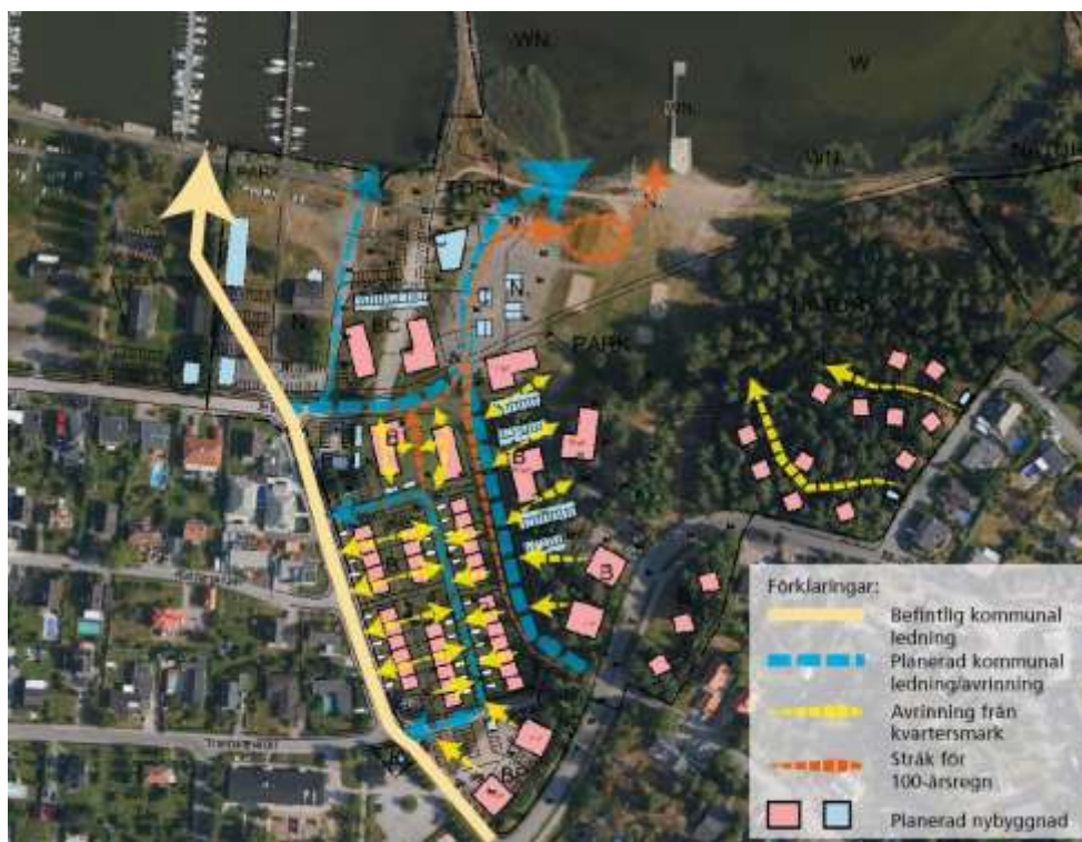
Figur 8. Principer för dagvattenstråk i aktuellt planförslag (Källa: Norrköpings kommun, 2015)
